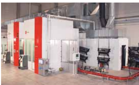
Die Kompakte Roboter-Lackierkabine ist eine hervorragende Ergänzung zu einer großen Produktionsanlage (wie oben abgebildet).
