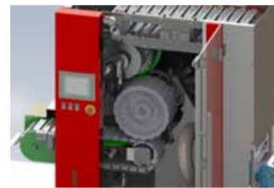
Das Bandtransportsystem kommt ohne Formateile aus.
