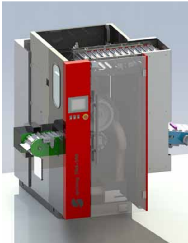
Das neue Trommelkonzept sorgt für eine präzise Positionierung der Aluminiumtuben.
