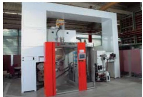
Für kontinuierliche Verfahrenstests und Kundenvorfürungen der HIL-70 wurde ein Transfersystem mit allen Übergabesituationen an die Innenlackiermaschine angebaut
