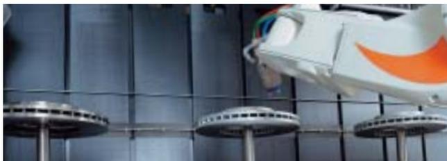
Selbst-reinigende Rakelwand mit Labyrinthfilter
