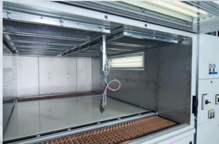
Coating of flat glass plates to manufacture solar modules with prime coating. Beschichtung von flachen Glasplatten für die Solarmoduleherstellung mit einem Primer.
