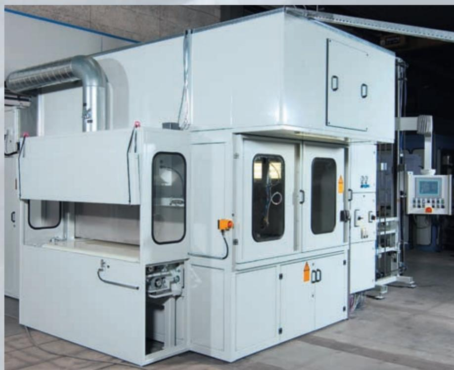
umlaufenden Endlos-Kunststoffband. Das Förderband ist mit 1.600 mm breiter als die Module, um eine Verunreinigung der Vorderseite des Glases durch Overspray zu verhindern. Die Platten passieren beim Einfahren in die Spritzkabine eine Schleuse, die zum einen verhindert, dass ungefilterte Hallenluft in den Spritzbereich gelangt, zum anderen das Austreten lösemittelhaltiger Luft aus der Anlage in die Halle unterbindet.
