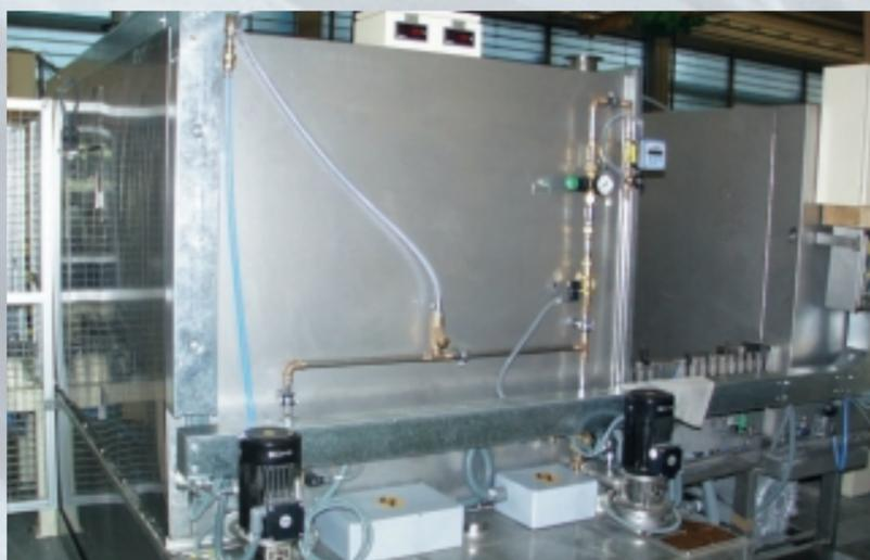
Sprimag Power-Wash Pre-treatment Unit / Sprimag Power-Wash Vorbehandlungsanlage
