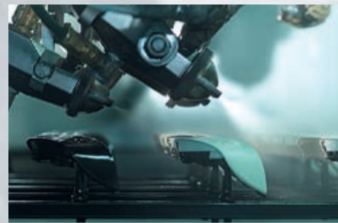
Silicone coating with a Sprimag Three-axis Coating Machine Beschichten von Silikon mit Sprimag Dreiaachsenautomat
