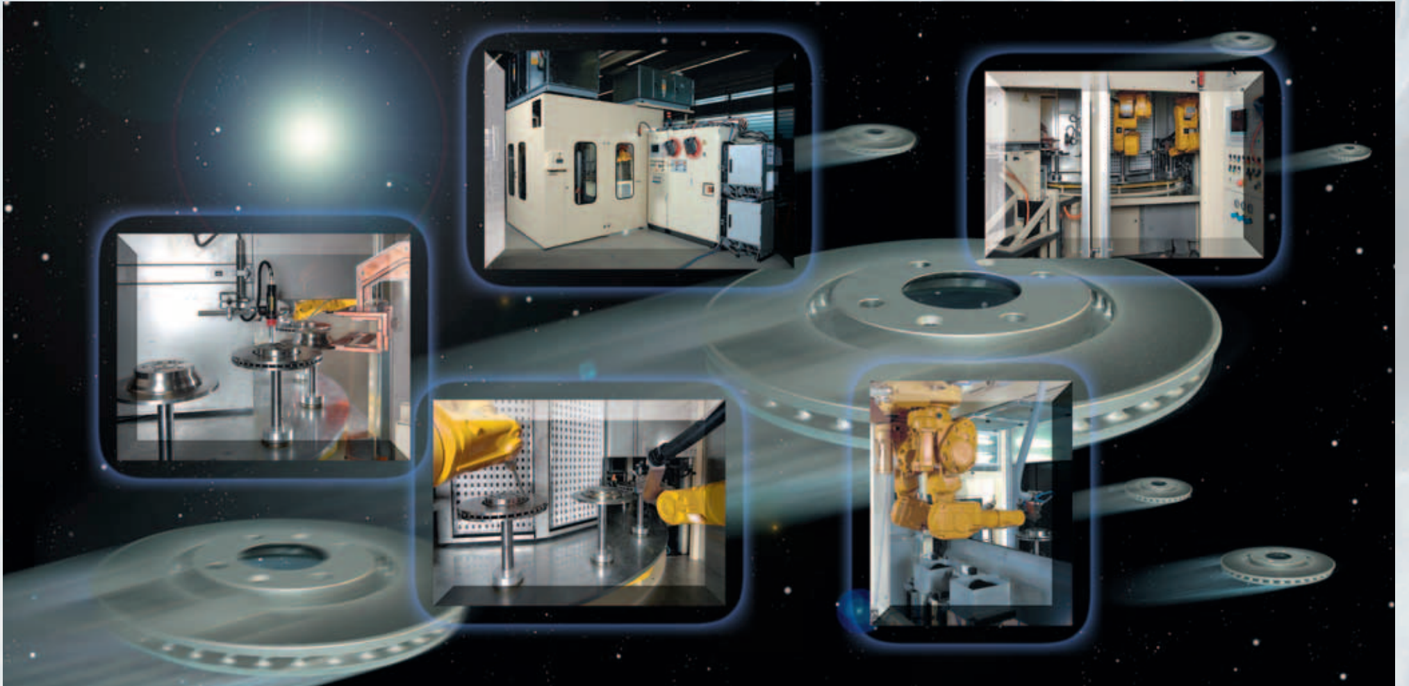
For example: Round Table Unit for coating of brake discs with parts' identification system, loading, robot spray station and inductive drying Zum Beispiel: Rundautomat zum Beschichten von Bremsscheiben mit Teileerkennung, Beladung, Roboterspritzstelle und induktiver Trocknung
