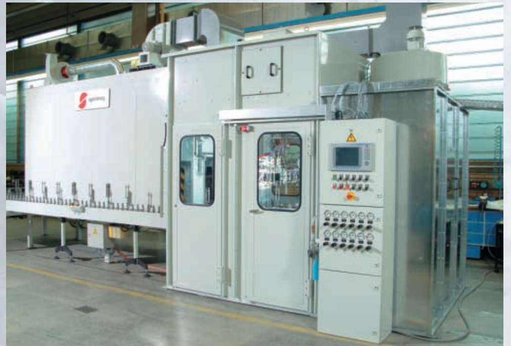
Example of coating machine: Chain-type Lacquering Machine with Duplex roller chain Anlagenbeispiel: Kettenautomat mit Duplex-Rollenkette
