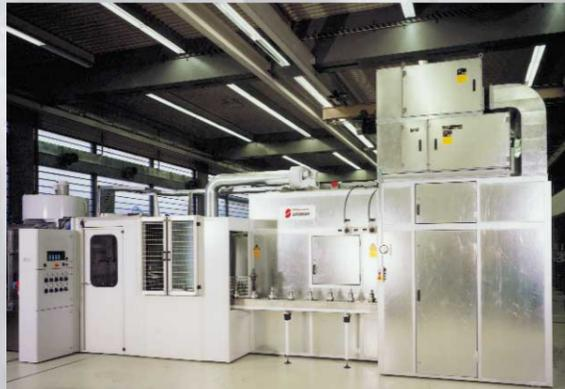
Installation automatique de vernissage à chaîne
