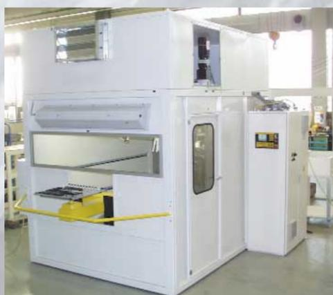
Installation automatique de vernissage à trois axes
