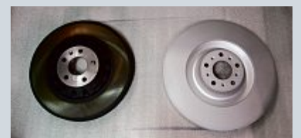
Die Bremsscheiben werden in Schwarz und Silber im Mixbetrieb lackiert
