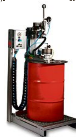
Lackversorgung für 200-Liter-Lackfässer
