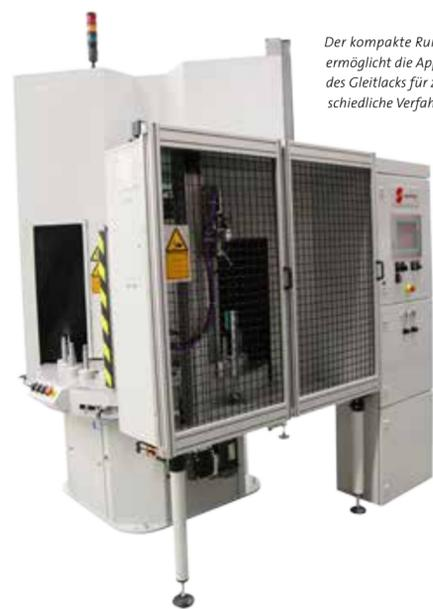
Der kompakte Rundautomat ermöglicht die Applikation des Gleitlacks für zwei unterschiedliche Verfahren
