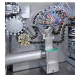
Aufgeräumte Komponenten und freier Zugang für Wartungsarbeiten: Die Verlegung der Absaugeneinheit schafft Platz und Sauberkeit.
