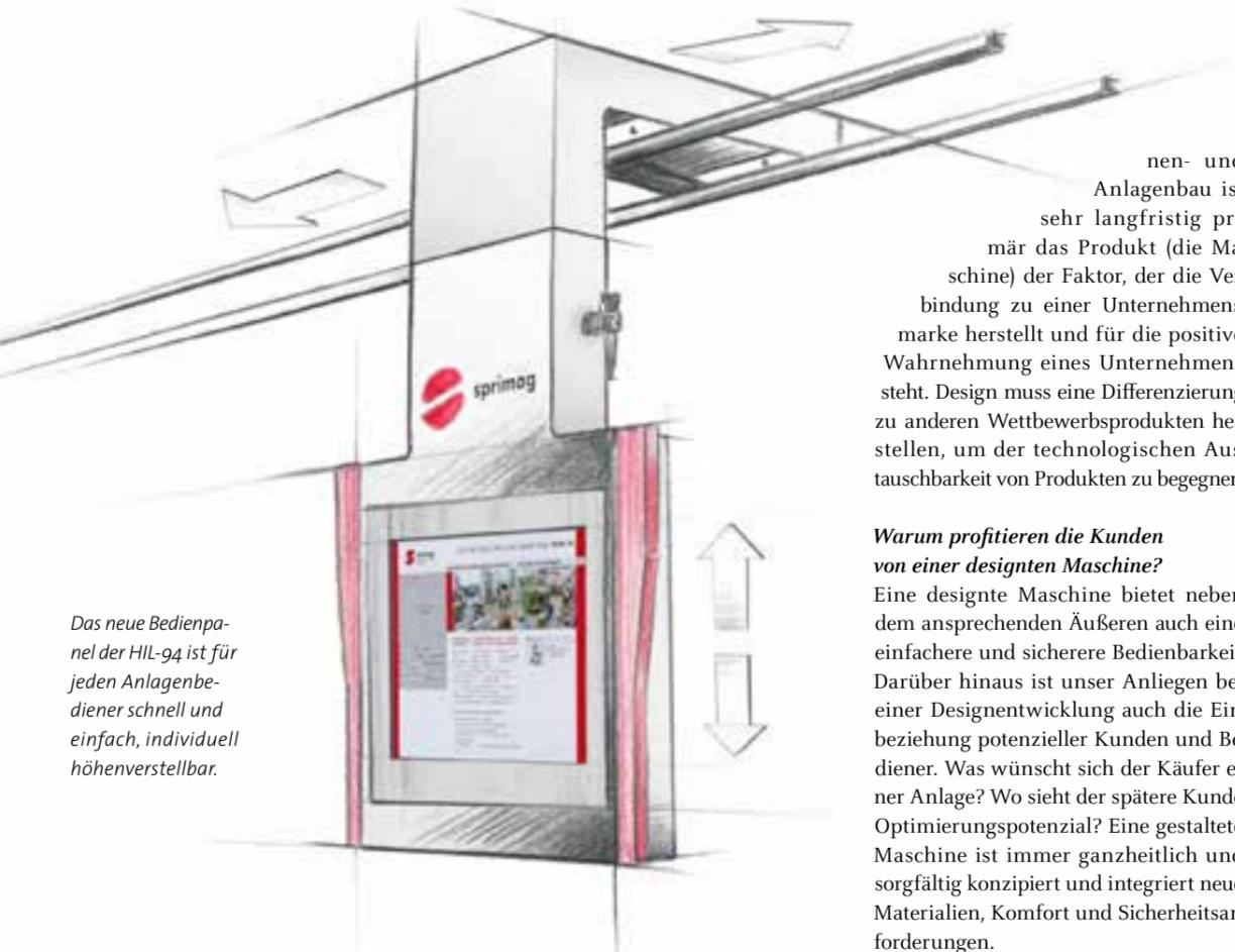
Das neue Bedienpanel der HIL-94 ist für jeden Anlagenbediener schnell und einfach, individuell höhenverstellbar.
