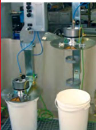
Mit Hilfe der Rührstation kann parallel zur laufenden Produktion der nächste Lack vorbereitet werden.
