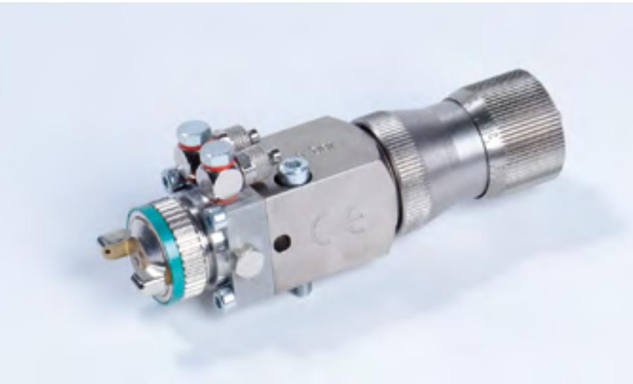
Der S-433 Kleinspritzapparat wird dann vorteilhaft eingesetzt, wenn kleinste Mengen an Beschichtungsmaterial benötigt werden. Durch seine leichte kompakte Bauweise, mit einer Länge von 110 mm gegenüber einem Standard-Spritzapparat mit 170 mm, ist er besonders platzsparend zum zielgenauen Lackieren von Kleinteilen geeignet.
