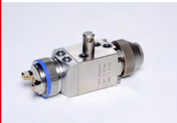
Beim Einsatz des S-7S K wird die ausgebrachte Lackmenge allein durch Veränderung des Materialdruckes verstellt. Durch den Wegfall der manuellen Materialmengenverstellung ist der Spritzapparat besonders kurz. Der S-7S K ist mit einer Luftkappenarretierung ausgestattet und in folgenden Variationen erhältlich:
