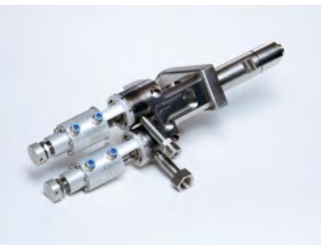
Die Sprimag Mischeinheit sorgt für eine totraumfreie Materialführung vom Dosierventil durch den Mischblock und die Mischkammer. Die Vorteile für den Kunden im Produktionsprozess: präzise Lackierungen, minimierte Wartezeiten und Kosten, Reduzierung von Ausschusszahlen und Steigerung der Anlagenverfügbarkeit durch ein kompromissloses Design aller beweglichen Teile. Optimierte Reinigungsergebnisse ermöglichen es noch flexibler verschiedene Lacke auf einer Mischanlage einzusetzen.
