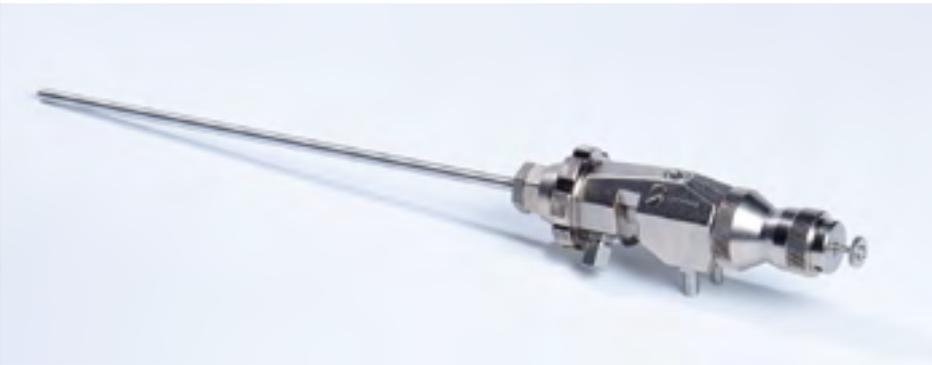
Der Spritzapparatekörper des S-233 Spritzapparates mit Düsenverlängerung entspricht dem konventionellen S-233 Spritzapparat. Die Düsenverlängerung dient zum Innenbeschichten verschiedenster Werkstücke, wie z. B. Tuben oder Dosen. Die bei allen Spritzapparaten des Typs S-233 angewendete Hochdrucktechnik sorgt für feinste Zerstäubung.
