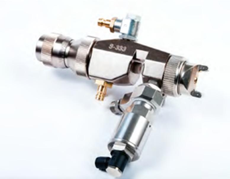
Das Sprimag Dumpventil erleichtert und beschleunigt das Spülen des Spritzapparates und der Materialleitung bei allen Systemen mit Stichleitung, wie zum Beispiel in 2K-/3K Anlagen mit automatischem Topzeitspülen. Das Dumpventil öffnet und schließt den Materialrücklauf. Das Material bzw. Lösemittel kann schnell durchfließen. Die Reinigungszeit wird dadurch wesentlich verkürzt. Durch die Rückleitung zum Dumpbehälter wird die Verschmutzung der Spritzkabine verringert.
