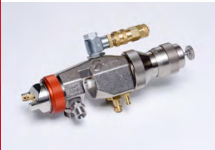
Mit dem Spritzapparat S-333 kann sowohl mit Lackumlauf als auch mit Stichleitung gearbeitet werden. Die Dichtbuchse aus reaktionsneutralem PTFE bedarf keiner Einstell- oder Nachstellarbeit. Beim Steuern des Spritzapparates schließt der Steuerkolben zuerst den Lackfluss und nach einer kurzen Zeitverzögerung die Zerstäuberluft. Dadurch wird unkontrolliertes Nachtropfen verhindert.
