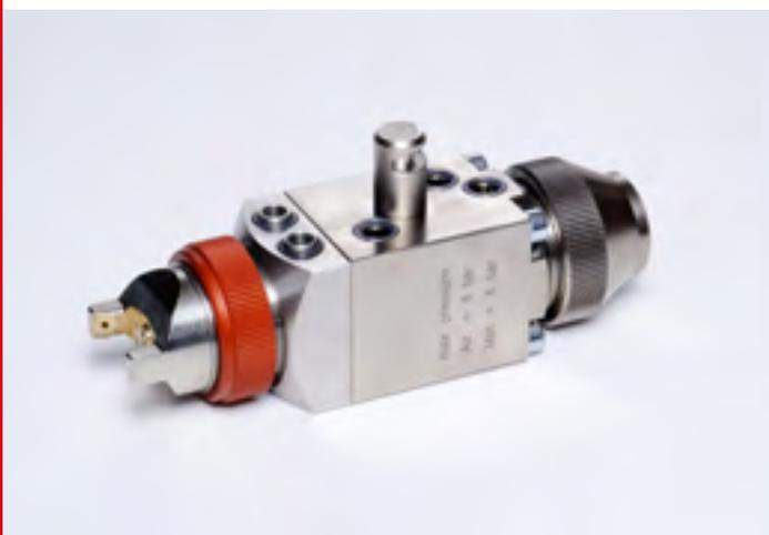
Beim Einsatz des S-7 K wird die ausgebrachte Lackmenge allein durch Veränderung des Materialdruckes verstellt. Durch den Wegfall der manuellen Materialmengenverstellung ist der Spritzapparat besonders kurz. Der S-7 K ist mit einer Luftkappenarretierung ausgestattet und in folgenden Variationen erhältlich:
