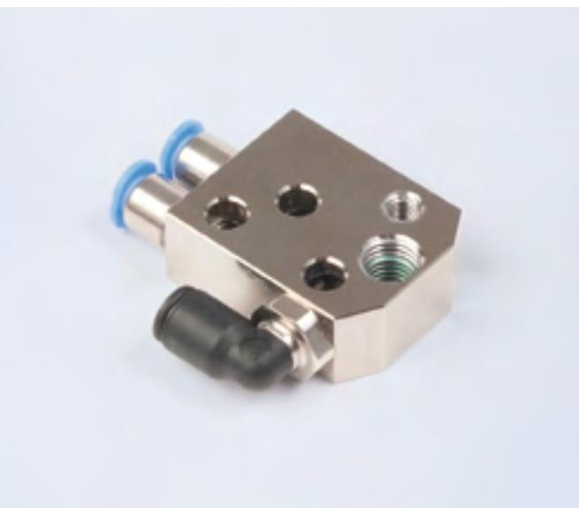
Mit der Schnellwechselplatte kann der Spritzapparat nach der Entkopplung leicht und schnell ausgetauscht werden, die voreingestellte Position bleibt erhalten. Die Schnellwechselplatte erlaubt eine einfache Trennung des Spritzapparatekörpers von den Druckluftschläuchen, die an der Schnellwechselplatte in der Maschine verbleiben.
