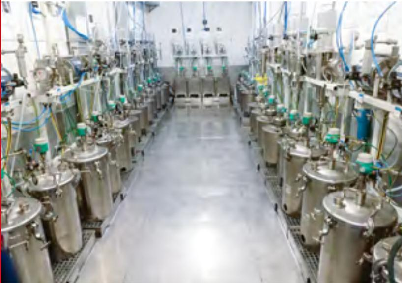
Die Lackversorgung nimmt in der Applikationstechnik einen immer wichtigeren Stellenwert ein. Durch die richtige Ausrüstung werden Fehler im Beschichtungsprozess vermieden, Prozesse verbessert und vereinfacht und Produktionskosten gesenkt. Sprimag deckt mit seinen Produkten zur Lackversorgung von der kleinsten Menge bis hin zur Mischanlage das gesamte Spektrum für eine optimale Beschichtungslösung ab.
