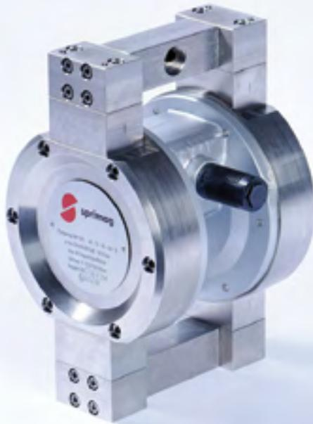
Die von Sprimag entwickelte Pumpe MP-SP2 wurde für Fördermengen von bis zu 6 l/min und einem Materialdruck bis 16 bar ausgelegt. Sie basiert auf dem zur schonenden Lackförderung bewährten Prinzip der Doppelmembranpumpe mit dem Übersetzungsverhältnis 1:1. Das totpunktfreie Umschaltventil gewährleistet in Verbindung mit in speziellen Führungen arbeitenden Kugelventilen der Flüssigkeitsseite geringste Pulsationen.
