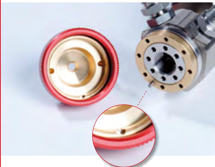
Den bewährten Spritzapparat S-333 gibt es jetzt auch mit einer Luftkappenarretierung. Der Vorteil: Die Luftkappe steht nach dem Abschrauben und Reinigen und nach dem erneuten Anbringen wieder an exakt derselben Position wie davor. Die Position der Luftkappe ist somit absolut reproduzierbar, d. h. es wird das gleiche Spritzbild an der gleichen Stelle abgebildet. Das zeitraubende Einjustieren auf die genaue Position nach dem Reinigen wird somit vermieden.
