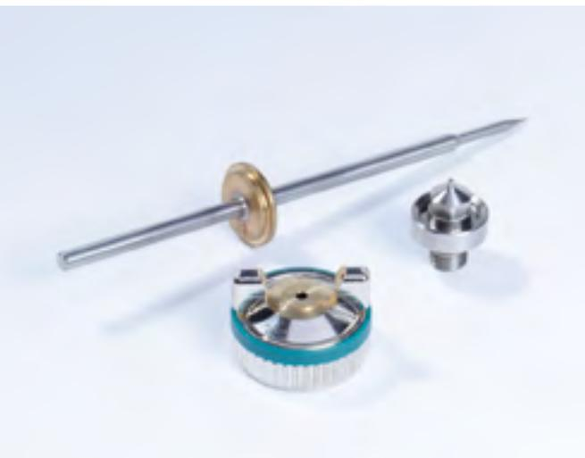
Ein Düsenatz besteht jeweils aus folgenden drei Komponenten: Düse, Luftkappe und Düsennadel und ist für verschiedene Düsenbohrungen erhältlich. Von 0,3 mm bis 0,8 mm.
