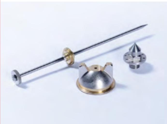
Ein Düsenatz besteht jeweils aus folgenden drei Komponenten: Düse, Luftkappe und Düsennadel und ist für verschiedene Düsenbohrungen erhältlich. Von 0,3 mm bis 1,5 mm.
