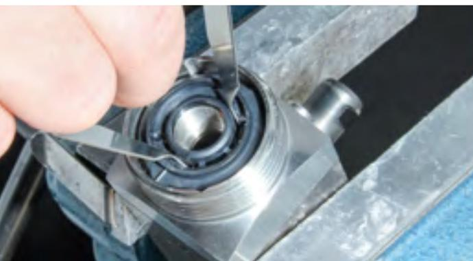
Bei Beschädigung und Undichtigkeit sollte der Luftverteilerling ausgetauscht werden. Das Werkzeugset enthält drei Luftverteilerlinge, ein Ausziehwerkzeug, sowie eine Ein- und Ausbauanleitung.
