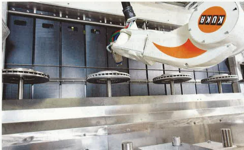
Der Kettenautomat eignet sich besonders für rotationssymmetrische Teile.
