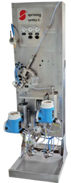
Die 2K-Lackversorgung der „Sprimix II“ passt der Hersteller an die Bedürfnisse des Kunden an, sodass nun auch kleine Durchflussraten kein Problem mehr darstellen. Foto: Sprimag
