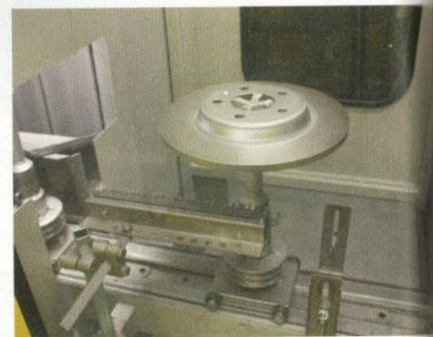
Fertig lackiert rollen die Bremscheiben auf dem drehbaren Steher Richtung Trockenofen.
