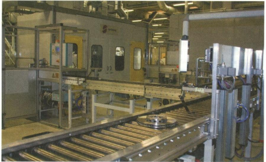
Drei Dreh- und Fräs-Bearbeitungslinien liefern die trocken bearbeiteten Bremsscheiben an die zwei Lackierkabinen der Sprimag-Anlage. Bilder: CB
