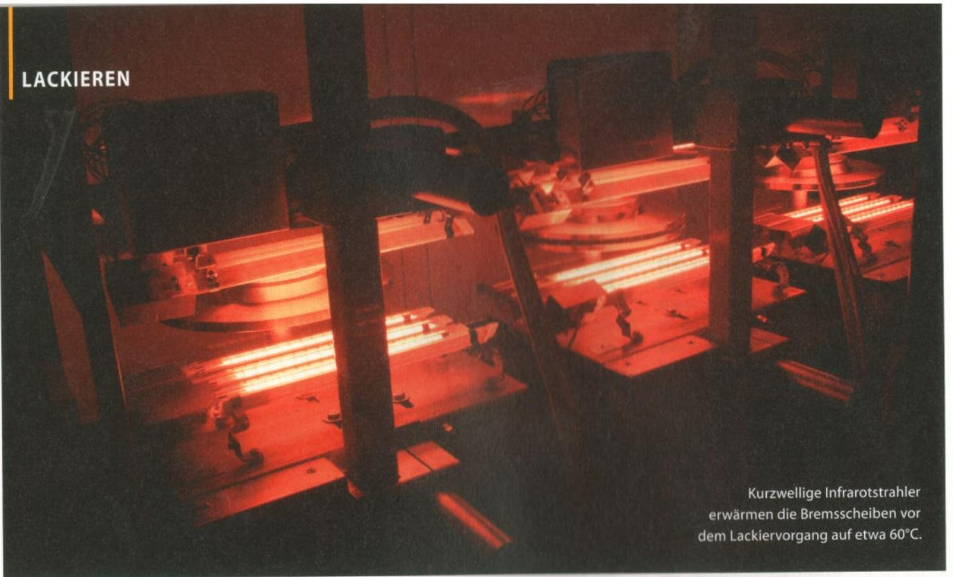
Kurzwellige Infrarotstrahler erwärmen die Bremscheiben vor dem Lackiervorgang auf etwa 60°C.
