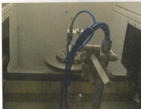
Späne und Bearbeitungsrückstände werden mit Pressluft abgeblasen.
