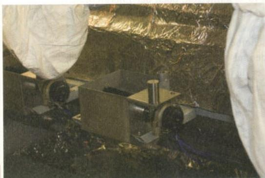
Automatische Reinigungsvorrichtungen für die Spritzpistolen reduzieren den manuellen Wartungsaufwand.
