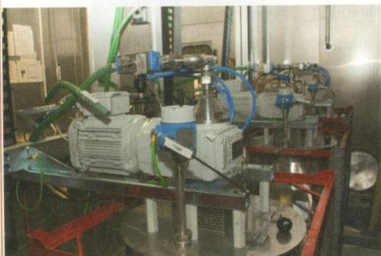
Wird ein Fass leer, schaltet die elektronische Steuerung der Farbversorgung um.
