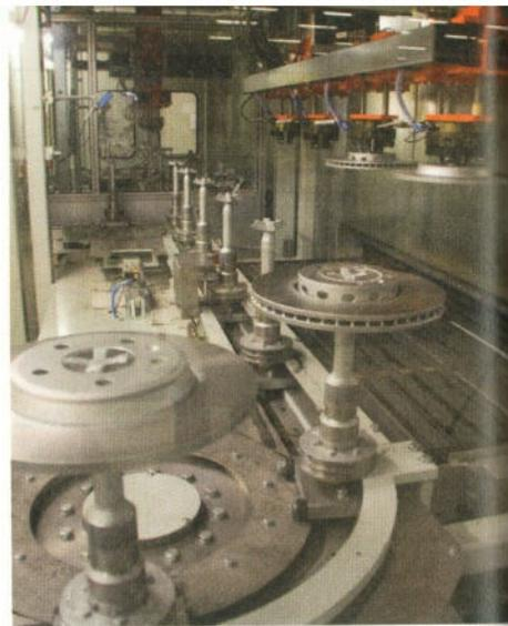
Nach dem Lackieren hebt eine spezielle Innen-Greifvorrichtung die Bremsscheiben von den Stehern ab und legt sie auf das Förderband des Trockenofens.
