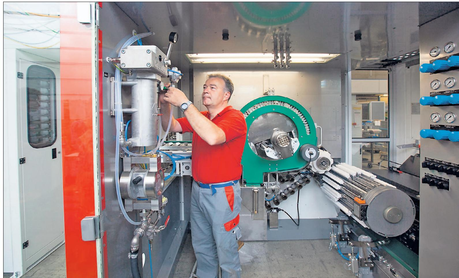
Jochen Niessner arbeitet an einer Innenlackiermaschine für Aluminiumtuben. Sprimag sieht sich in diesem Bereich als Technologieführer.
