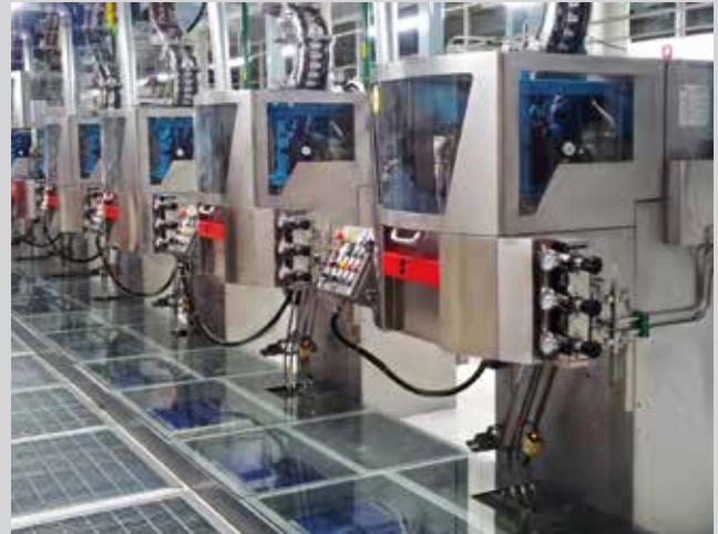
Modulkombination für hohe Gesamtleistung – auf Podest vormontiert
