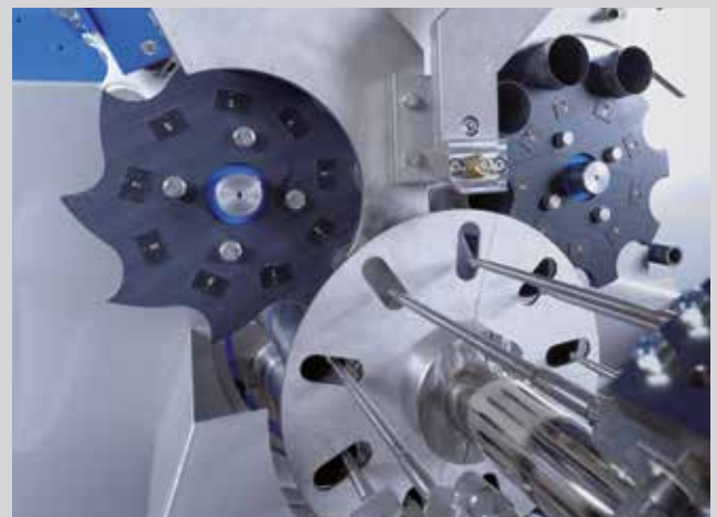
Dosentransfer über Ein- und Auslaufstern auf Vakuumplatte
