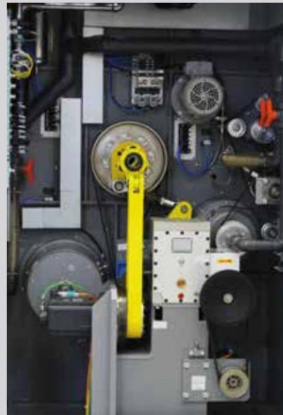
Kompaktes Servo- antriebskonzept mit getrenntem Hub-Schwenk- antrieb und guter Zugänglichkeit für Wartungsarbeiten
