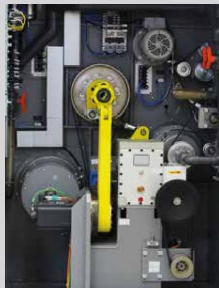
Kompaktes Servoantriebskonzept mit getrenntem Hub-Schwenkantrieb und guter Zugänglichkeit für Wartungsarbeiten
