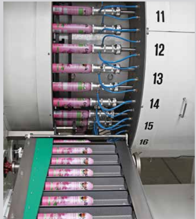
30 Prüfköpfe mit praxiserprobtem Abdichtsystem garantieren lange Prüfzeiten und Prüfpräzision
