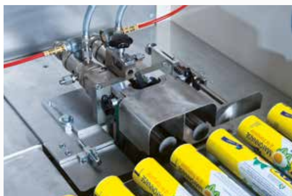
Latexierung mit 2 Highend-Schleuderapparaten S-540 auf formatunabhängigem Transportband
