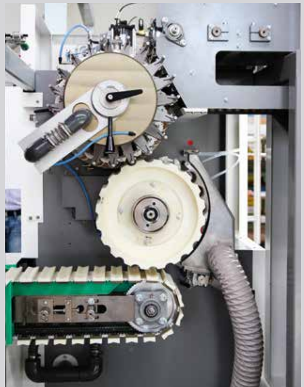
Trommelkonzept für präzise Positionierung der Aluminiumtuben
