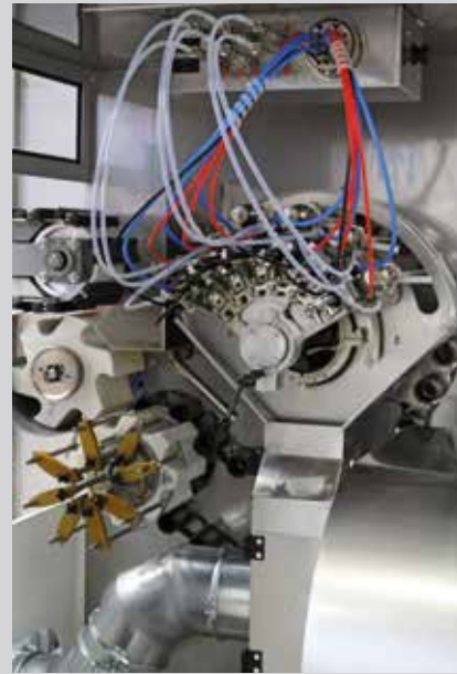
6/4 Spritzapparat- ratehalter mit Schnellwechsel- Einspeisung
