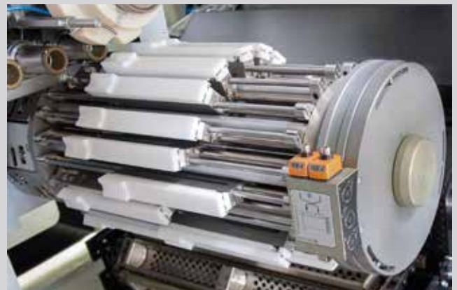
Bewährtes Übergabekonzept durch kombinierte Transfertrommel in den Innenlacktrockner
