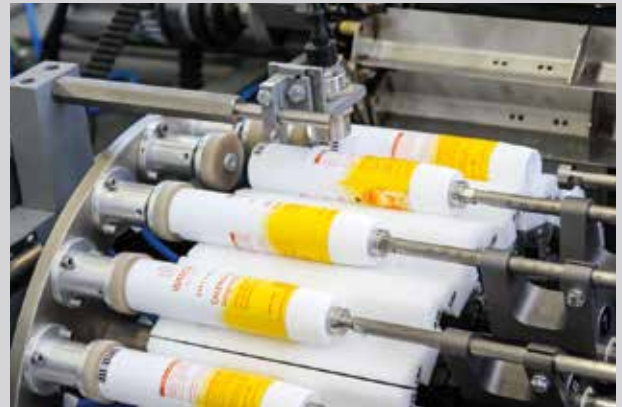
20 Prüfköpfe prüfen bis zu 200 Aluminiumtuben pro Minute auf Löcher und Risse mit Durchmessern ab 0,04 mm
