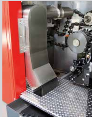
Integrierte Teile-ausschleusung aus laufendem Produktionsprozess (Einzel- oder Gruppenvorwahl)
