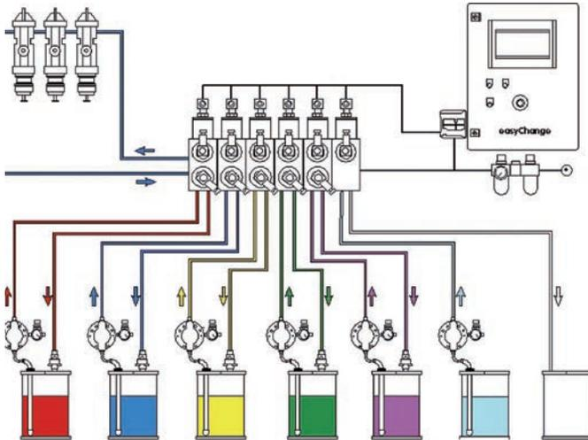
Mit easyChange erhalten Sie ein Konzept für einen integrierten, schnellen und sauberen Farbwechsel. easyChange ist für den Einsatz in automatischen Lackieranlagen konstruiert und ist auch nur zum Spülen geeignet.
