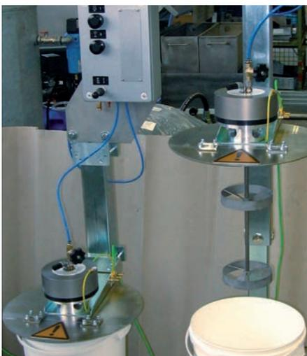
Mit Hilfe der Rührstation kann parallel zur laufenden Produktion der nächste Lack vorbereitet werden.
