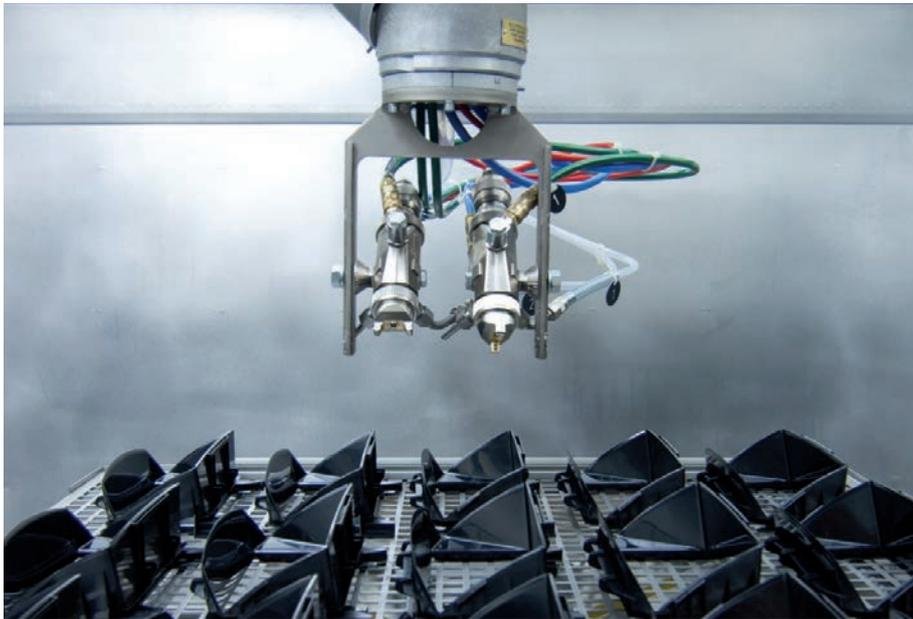
Der Außenspritzapparat S-333 ist für alle Beschichtstoffe wie Wasserlacke, Lösemitellacke, UV-Lacke, Softlacke, Glasuren, Emulsionen usw. bestens geeignet.
