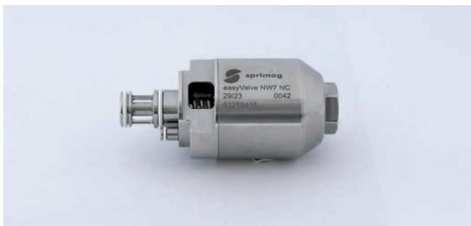
Das Medienventil easyValve NC ist ein normal geschlossenes, pneumatisch steuerbares 2/2 Wegeventil. Es ist für Lacke, Härter, Druckluft, Wasser und Lösemittel geeignet. Es wird in Kombination mit Sprimag Ventilblöcken verwendet.
