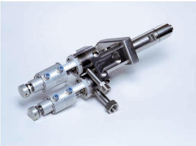
Die Sprimag Mischeinheit sorgt für eine tottraumfreie Materialführung vom Dosierventil durch den Mischblock und die Mischkammer. Die Vorteile für den Kunden im Produktionsprozess: präzise Lackierungen, minimierte Wartungszeiten und Kosten, Reduzierung von Ausschusszahlen und Steigerung der Anlagenverfügbarkeit durch ein kompromissloses Design aller beweglichen Teile. Optimierte Reinigungsergebnisse ermöglichen es noch flexibler verschiedene Farben auf einer Mischanlage einzusetzen.
