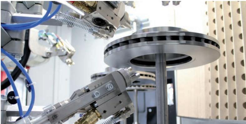
Der Sprimag-Spritzapparat S-7 ist ein automatisch arbeitender Spritzapparat zur pneumatischen Zerstäubung von Lacken und Farben. Durch sein bedienerfreundliches neues modulares Design und seine auf bewährter Technik basierende Funktionalität bietet er deutliche Vorteile gegenüber den bekannten Spritzapparat S-233 und S-333.
