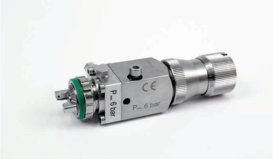
Der S-433 Kleinspritzapparat wird dann vorteilhaft eingesetzt, wenn kleinste Mengen an Beschichtmaterial benötigt werden. Durch seine leichte kompakte Bauweise, mit einer Länge von 110 mm gegenüber einem Standard-Spritzapparat mit 170 mm, ist er besonders platzsparend zum zielgenauen Lackieren von Kleinteilen geeignet.
