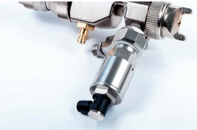
Das Sprimag Dumpventil erleichtert und beschleunigt das Spülen des Spritzapparates und der Materialleitung bei allen Systemen mit Stichleitung, wie zum Beispiel in 2K-/3K-Anlagen mit automatischem Topzeitspülen. Das Dumpventil öffnet und schließt den Materialrücklauf. Das Material bzw. Lösemittel kann schnell durchfließen. Die Reinigungszeit wird dadurch wesentlich verkürzt. Durch die Rückleitung zum Dumpbehälter wird die Verschmutzung der Lackierkabine verringert.
