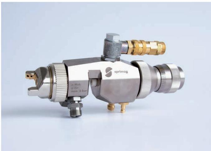
Mit dem Spritzapparat S-333 kann sowohl mit Lackumlauf als auch mit Stichleitung gearbeitet werden. Die Dichtbuchse aus reaktionsneutralem, lösemittelbeständigem Kunststoff bedarf keiner Einstell- oder Nachstellarbeit. Beim Steuern des Spritzapparates schließt der Steuerkolben zuerst den Lackfluss und nach einer kurzen Zeitverzögerung die Zerstäuberluft. Dadurch wird unkontrolliertes Nachtropfen verhindert.
