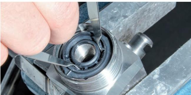
Bei Beschädigung und Undichtigkeit sollte der Luftverteilerling ausgetauscht werden. Das Werkzeugkit enthält drei Luftverteilerlinge, ein Ausziehwerkzeug sowie eine Ein- und Ausbauanleitung.
