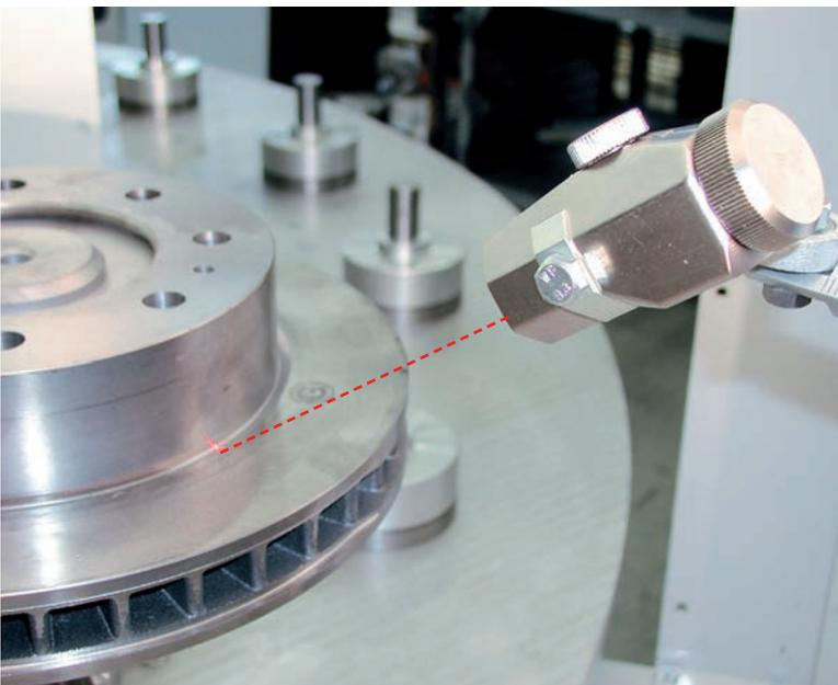
Einstellhilfe zur punktgenauen Justierung des Spritzhalters mittels Laserpointer. Kompatibel mit den Spritzapparatehalterungen für S-233, S-333, S-7 und S-7S.
