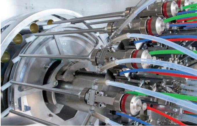
Als Nachfolger des S-233, welcher bisher Standards bei der Tuben- und Doseninnenlackierung setzte, besticht der neue S-803 nun mit attraktiven Features. Dabei profitiert der neue Spritzapparat von Weiterentwicklungen in der Apparatetechnologie, die Sprimag bei anderen Beschichtungsprozessen erreicht hat. Diese Verbesserungen wurden nun auch für den Einsatz in Aerosoldosen-Innenlackieranlagen umgesetzt.
