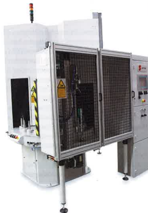
Die Lineareinheit mit der Applikationstechnik ist durch vergitterte Schutztüren einsehbar.
